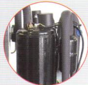
Rotacijski kompresor posebno je razvijen za toplinske pumpe. Potrošnja električne energije je za 31% niža u odnosu na klipni kompresor. Dizajn rotora osigurava tiši rad, besprijekoran start iz stand - by funkcije, čak i nakon nekoliko mjeseci stajanja.
